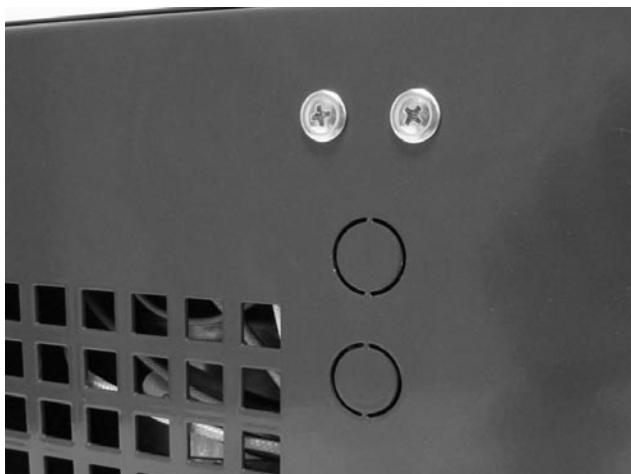
Рис. 11 – закрытые отверстия, которые изначально предусматривались для датчиков температуры TS и TV (можно использовать для иных целей)
