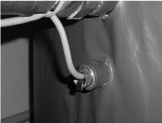
Рис. 13 – датчик температуры воды, установленный в отверстии расширительного бака (TV и TS)
