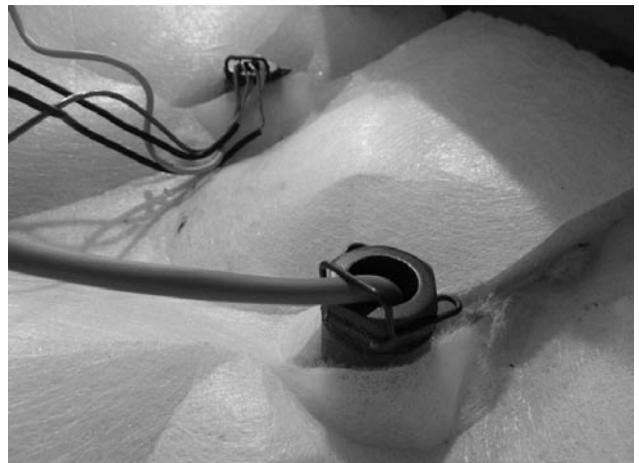
Рис. 16 – датчик температуры воды ТК в отверстии котла, тип DxxP
