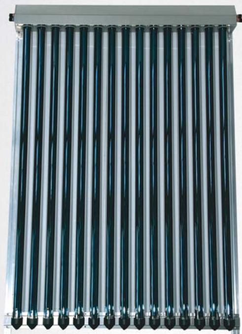
Коллектор с вакуумной трубкой мощностью 1090 Вт (при 1000Вт / м<sup>2</sup> освещенности), предназначена для портретной установки на крыше. Трубка состоит из 2 коаксиальных стеклянных трубок вакуумом между ними. Алюминиевая ламель установлена близко к стеклянной трубке собирает тепло со всей внутренней поверхности вакуумной трубки, давая теплу уходить в солнечную жидкость внутри медной трубы. Эти медные трубы присоединяются к коллектору, изолированные с 30 мм минеральной ваты.
