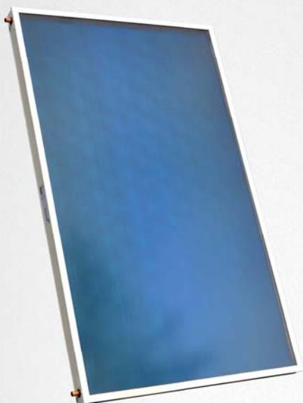
Плоский коллектор с выходной мощностью 1802 Вт (при 1000 Вт / м<sup>2</sup> освещенности), предназначен для портретной установки на крыше. Поглотитель арфа видный с высокоселективной поверхностью TiNOx, лазерной сваркой медных труб. Изоляция состоит из 40 мм минеральной ваты. Подключения расположены с обеих сторон сверху и снизу.
