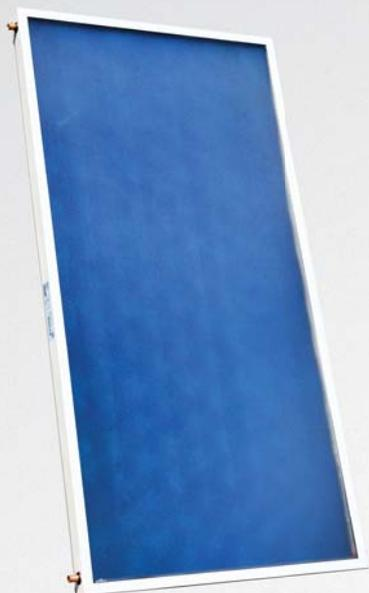
Плоский коллектор с выходной мощностью 1481 Вт (при 1000 Вт / м<sup>2</sup> освещенности), предназначен для портретной установки на крыше. Поглотитель арфа видный с высокоселективной поверхностью TiNOx, лазерной сваркой медных труб. Изоляция состоит из 40 мм минеральной ваты. Подключения расположены с обеих сторон сверху и снизу.
