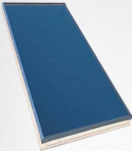
Пластинчатый коллектор мощностью 1808 Вт (при облучении 1000 Вт/м<sup>2</sup>), предназначенный для вертикальной установки на крыше. Арфа видный абсорбер с высокоселективной поверхностью TiNOx который приварен к медным трубам лазерной сваркой. Изоляция состоит из 50 мм минеральной ваты. Соединения вертикальные сверху.
