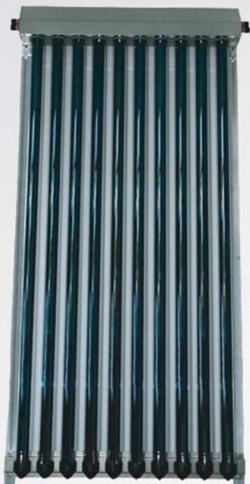
Коллектор с вакуумной трубкой мощностью 727 Вт (при 1000Вт / м<sup>2</sup> освещенности), предназначена для портретной установки на крыше. Трубка состоит из 2 коаксиальных стеклянных трубок с вакуумом между ними. Алюминиевая ламель установленная близко к стеклянной трубке собирает тепло от всей внутренней поверхности вакуумной трубы, передавая в солнечную жидкость внутри медной трубы. Эти медные трубы присоединяются к коллектору, с изоляцией 30 мм минеральной ваты.
