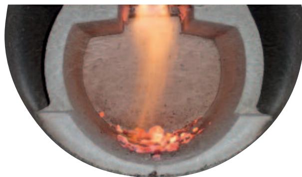
Горение газа в керамической топке T = 1000-1200 С°
