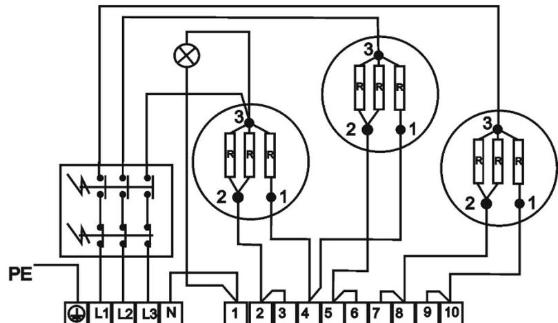
8kW 3 PE-N AC 400V / 50Hz
