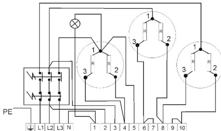
3kW 1 PE-N AC 230V / 50Hz
