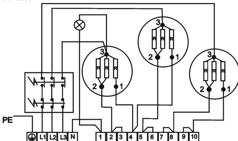
5kW 3 PE-N AC 400V / 50Hz
