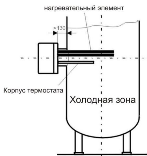
Фланец слишком длинный и высоко приварен. Гильза термостата под нагревательным элементом.
